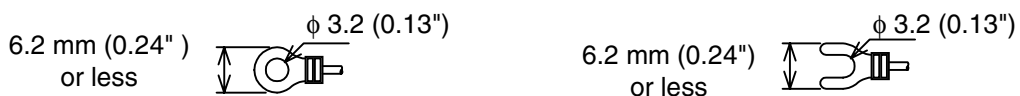
Figure 4.2: ENG ☞ Crimp Terminals for M3. Screws FRE ☞ Cosse de câble avec raccordement serti pour vis M3 GER ☞ Kabelschuhe mit Quetschanschluss für M3-Schrauben ITL ☞ Capocorda con collegamento a scatto per viti M3 ESP ☞ Manguitos de cable con conexión de apriete para tornillos M3
